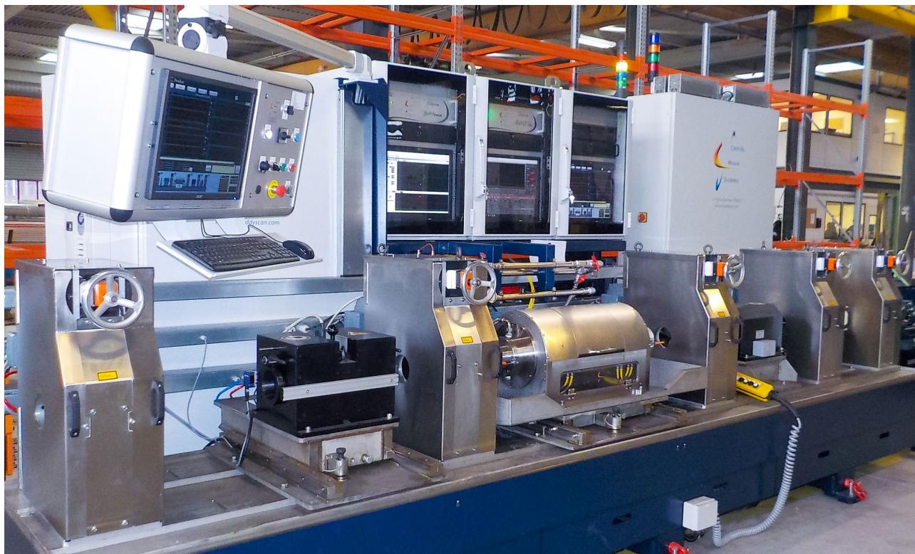
Комбинированная установка для вихретокового и ультразвукового контроля с инструментами Zet@Premium и MultiUTScan
