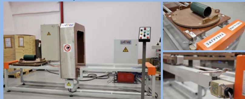
Полуавтоматические установки для размагничивания деталей в условиях производства, ремонта и эксплуатации
