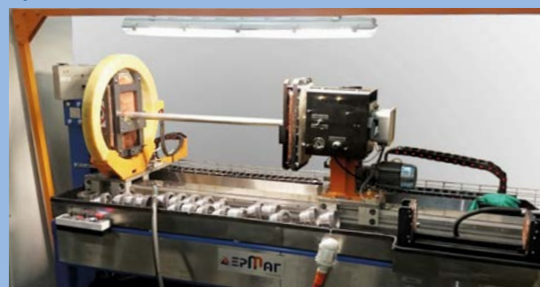
Магнитопорошковые дефектоскопы серии ErMag для контроля деталей из ферромагнитных сплавов
