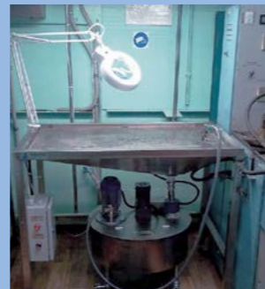
Поливные устройства для магнитной суспензии
