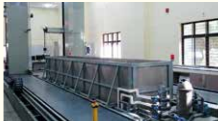
Рис. 4. Объединённый струйный/иммерсионный метод в автоматизированной системе производства ScanMaster System (IRT) Ltd.
