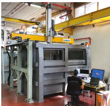
DS-200i: иммерсионная ванна установлена на полу
