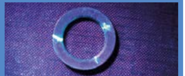
垫圈有穿透径向的裂缝
