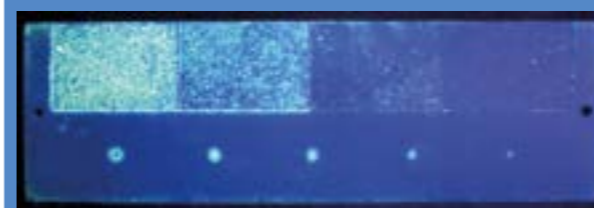
试验板。星形裂缝
