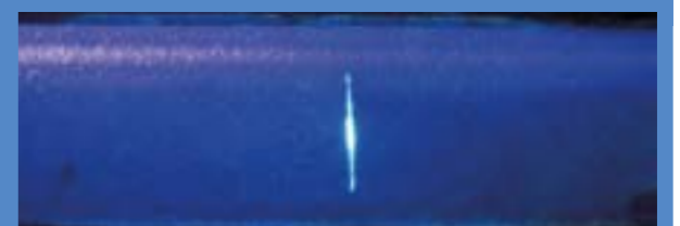
1号试验板1 千分尺宽度裂缝
